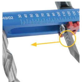
Abb. 1.: Die Gravur der Klingen (R / L) muss immer in Richtung des Bohrers zeigen.
