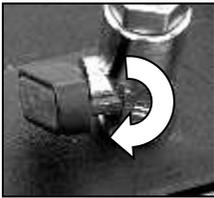
Zum Lösen der Vakuumbefestigung schließen Sie den Kugelhahn. Damit wird ein Entlüftungsventil geöffnet, über das das Vakuum entweichen kann.
