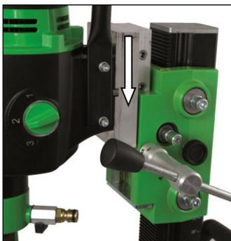
De montageplaat wordt op de boormotor gezet met de plaatsingsleutel en bevestigd met de 4 bouten.
