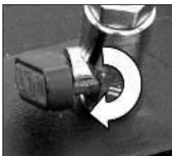
Do demontażu mocowania próżniowego, zamknąć zawór kulowy. Spowoduje to otworenie zaworu napowietrzającego, przez co wyrówna się ciśnienie w podstawie z ciśnieniem atmosferycznym. W razie potrzeby można w ten sposób przestawić statyw przy pracującej pompie próżniowej.
