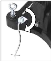
Zaznaczyć środek wykonywanego otworu. Odchylić wskaźnik środka otworu do oporu (patrz rys). Spozycjonować w taki sposób statyw, aby wierzchołek wskaźnika pokazywał dokładnie środek otworu przed ostatecznym zamocowaniem statywu, przechylić wskaźnik z powrotem do wyjściowej pozycji.
