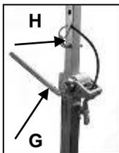
Posicionamento da coluna de perfuração. Posicione a escora de fixação rápida o mais próximo possível por trás do suporte na base da coluna de perfuração. Fixe a coluna de perfuração rodando a manivela (G) no sentido horário. Fixe na posição por meio do parafuso apropriado (H).
