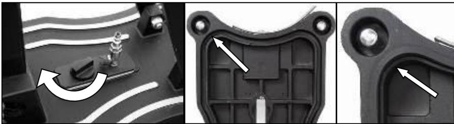
Certifique-se de que o parafuso de nivelamento está ajustado de modo a não sobressair do fundo da base, pois caso contrário o vácuo será afetado e o equipamento poderá soltar-se da superfície de montagem.
