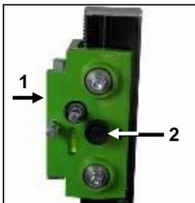
Aby odblokować wózek (1), wyciągnij przycisk bezpieczeństwa (2).
