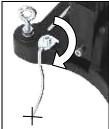
Markieren Sie die Mitte der zu erstellenden Bohrung. Klappen Sie den Bohrlochmittenanzeiger bis zum Anschlag aus (siehe Abb.). Positionieren Sie den Bohrständer so, dass die Spitze des Anzeigers genau auf die Markierung der Bohrlochmitte zeigt. Nachdem der Bohrständer fest montiert ist, klappen Sie den Bohrlochmittenanzeiger wieder ein.
