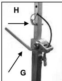
Plaats de boorinstallatie op de gewenste plek. Plaats de snelsteuneenheid zo dicht mogelijk achter de ondersteuning op de basis van de installatie. Bevestig de boorinstallatie door de arm (G) rechtsonder te draaien. Zet het vast in positie d.m.v. de daarvoor bestemde bout (H).
