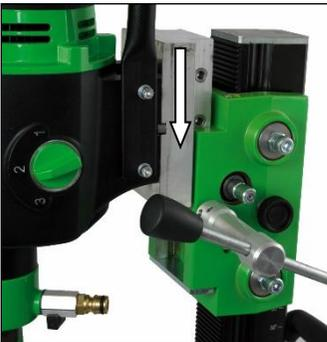
A placa de montagem é colocada de tal forma com a chave de ajuste na máquina que a tomada fique na placa de montagem do mesmo lado que o interruptor da máquina. Em seguida, insira os quatro parafusos e aperte-os firmemente.
