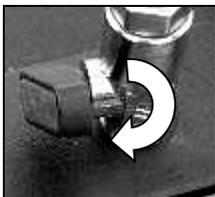
Para libertar a fixação por vácuo, feche a válvula. Isto abre uma válvula de purga através da qual o vácuo pode escapar. Assim, o equipamento pode ser ativado, se necessário, quando a bomba de vácuo estiver em funcionamento.
