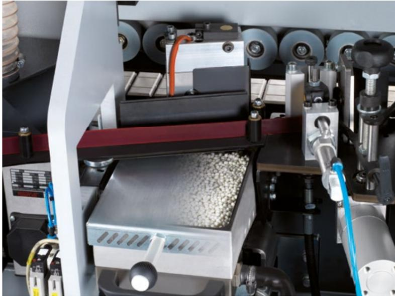
**Infrarot-Heizlampe für bessere Kantenhaftung bei kalten Werkstücken**
