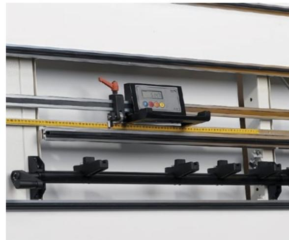
**Digitalanschlag für vertikale Schnitte**
